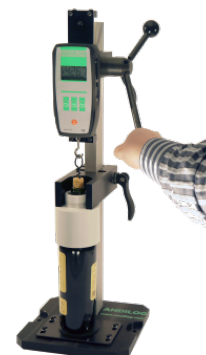
Extractor , für die manuelle Messung der Zugkraft an Korken
